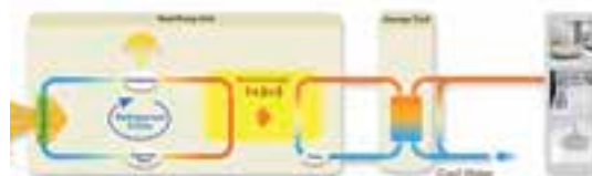
СХЕМА ГРУППОВОГО МОНТАЖА НАРУЖНЫХ БЛОКОВ RSJ НА ОБЩИЙ БАК
