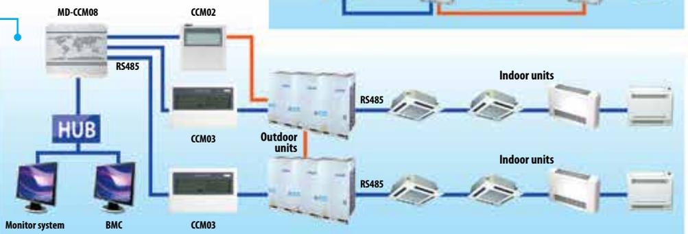
Структурная схема – пример построения сетевого управления системами MDV с выводом информации на шину сети Modbus.
