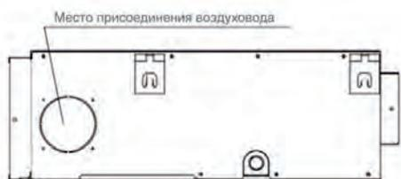
Возможна подача свежего воздуха в помещение через специально подготовленное отверстие в корпусе блока.
