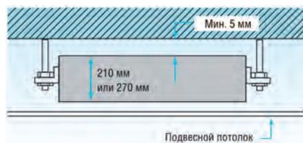
Высота всего 210 мм (модель 18) или 270 мм (модели 24–36).
