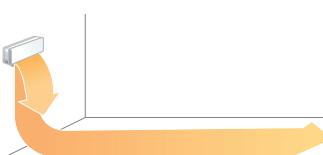
Заслонка закручивает поток воздуха вниз, обеспечивая более эффективный обогрев
