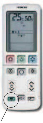
В режиме охлаждения, обогрева и т.п. нажмите кнопку функции Eco-sensor на пульте дистанционного управления.
