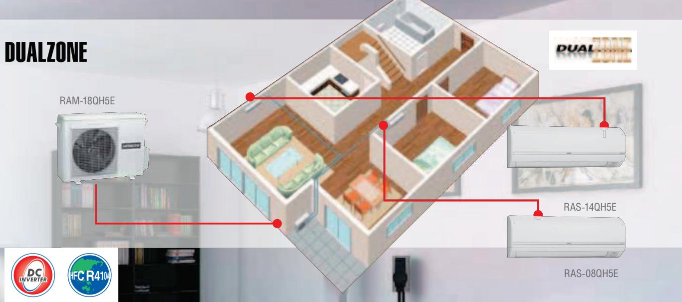
Инверторная мульти-сплит система Dualzone позволяет подключить к одному наружному блоку RAM-18QH5E два внутренних, производительностью 1.8, 2.5 и 3.5 кВт, выбираемых в зависимости от размеров помещений и тепловой нагрузки. Система может работать как в режиме охлаждения, так и в режиме нагрева и поддерживать разную температуру в каждом помещении
