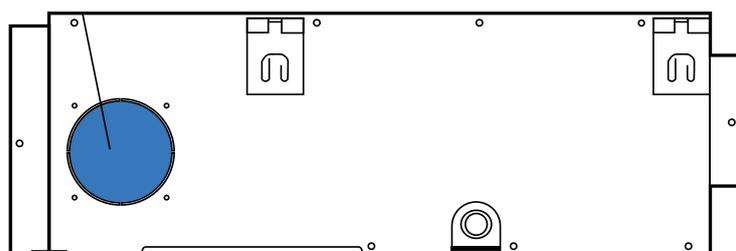
Специальное отверстие внутреннего блока канальных сплит систем Hyundai позволяет легко и просто обеспечить подключение подачи свежего воздуха в помещение
