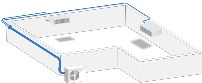
Внутренние блоки канальной сплит-системы могут быть установлены по принципу мульти системы совместно с одним наружным блоком\*. Внутренний блок можно комбинировать в любой из доступной комбинации. Использование данной возможности позволяет использовать кондиционер для охлаждения сразу нескольких помещений.
